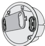
Na krabici KU přiložte montážní přípravek a přišroubujte
