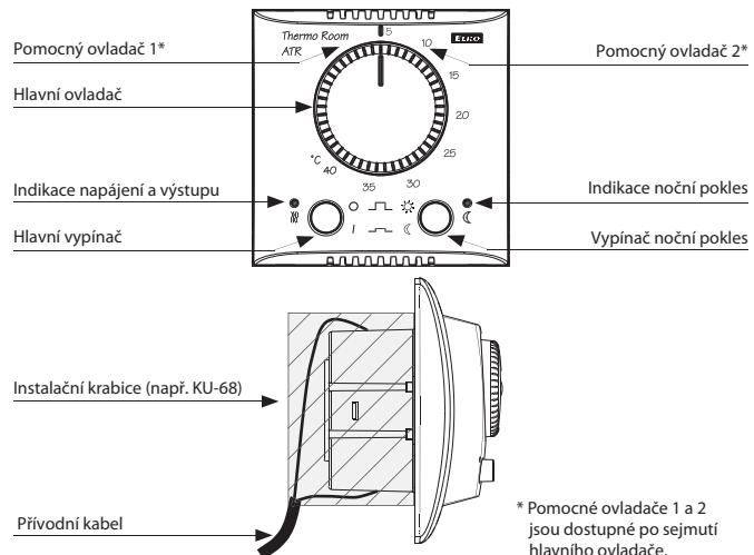
\* Pomocné ovladače 1 a 2 jsou dostupné po sejmuti hlavního ovladače.
